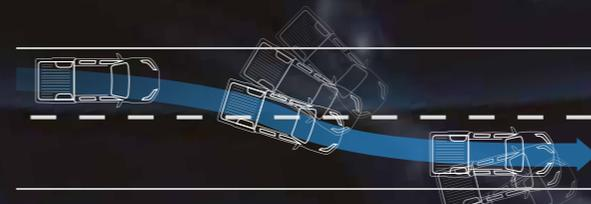
Para reduzir o deslizamento da roda, o VDC controla o torque do motor e a pressão dos freios, melhorando a estabilidade do veículo.
